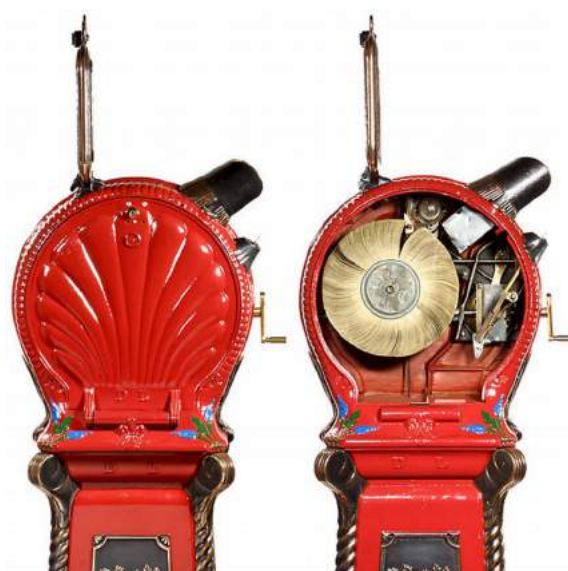
Le Mutoscope (fermé et ouvert). Photo: disponible sur http://www.darrahglass.com/779 consulté le 07/05/2017
